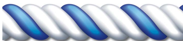
Paso de cableado
